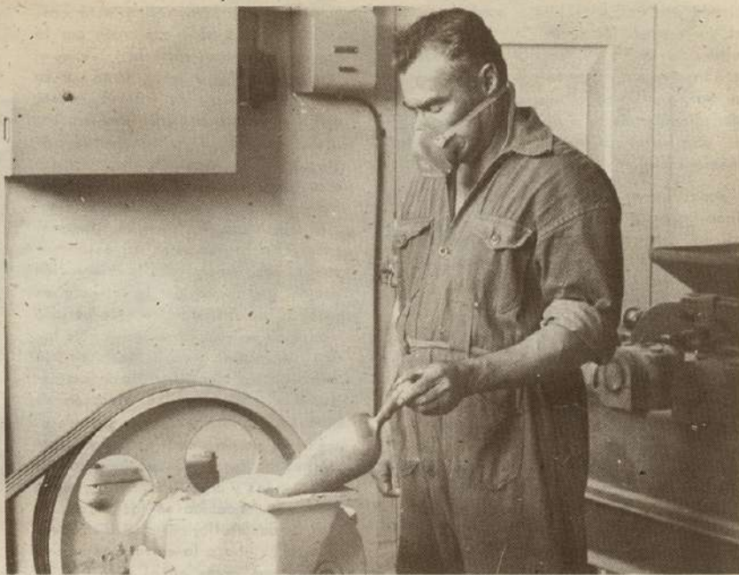
Operario trabaja en la obtención de muestras en un molino de discos.
