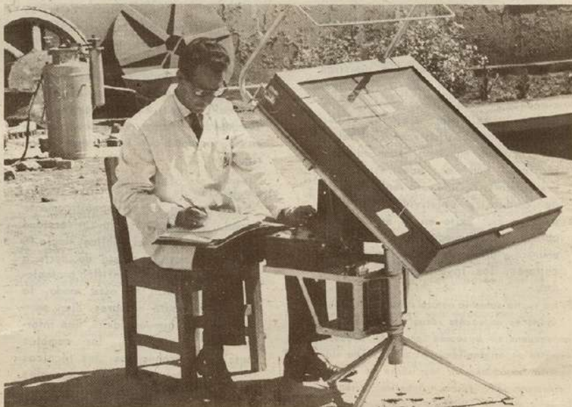
El Sr. Pedro Mladinic P., controlando selectividad de placas en investigaciones de energía solar. La unidad de control fué diseñada y construída en el Instituto.
